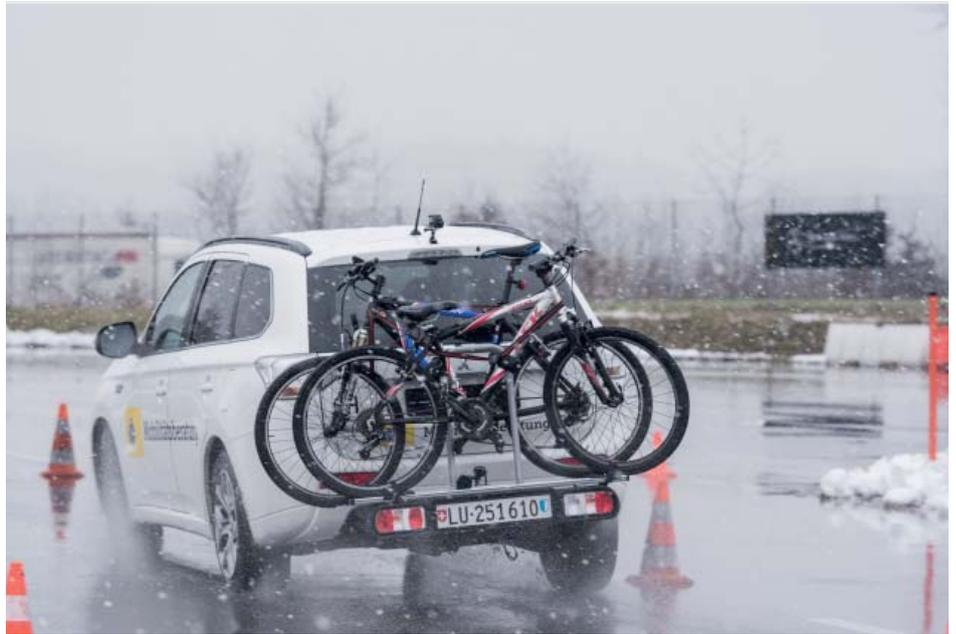
Si le porte-vélos est monté sur le crochet d'attelage, veiller à un serrage suffisant pour éviter qu'il ne bouge en cas de manœuvre d'évitement.
